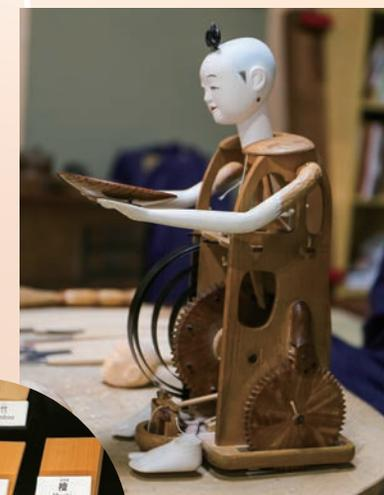
や歯車などの内部構造が見えて、本当にロボットみたいだ。ちなみに茶運び人形の動作のスイッチは湯呑みだ。両手で持つ茶托に湯呑みを置くと、その重量でスイッチが入り、畳一畳分をトコトコと移動する。湯呑みを取ると止まり、再び湯呑みを置くとUターンして戻っていくという仕掛けだ。畳一畳分以内であれば、回転距離は自由に設定できるのだという。そんな機械
